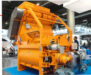
p. 38 – Le malaxeur est le point névralgique de la production du béton, en termes d'homogénéité et de qualité du mélange.
